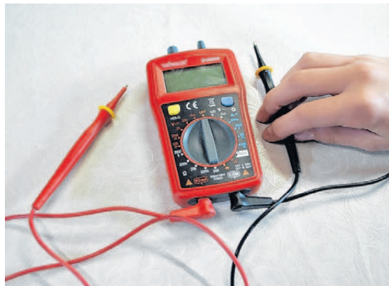
Hauke benutzt oft ein Multimeter, mit dem die elektrische Spannung, die Stromstärke und der elektrische Widerstand gemessen werden können.
